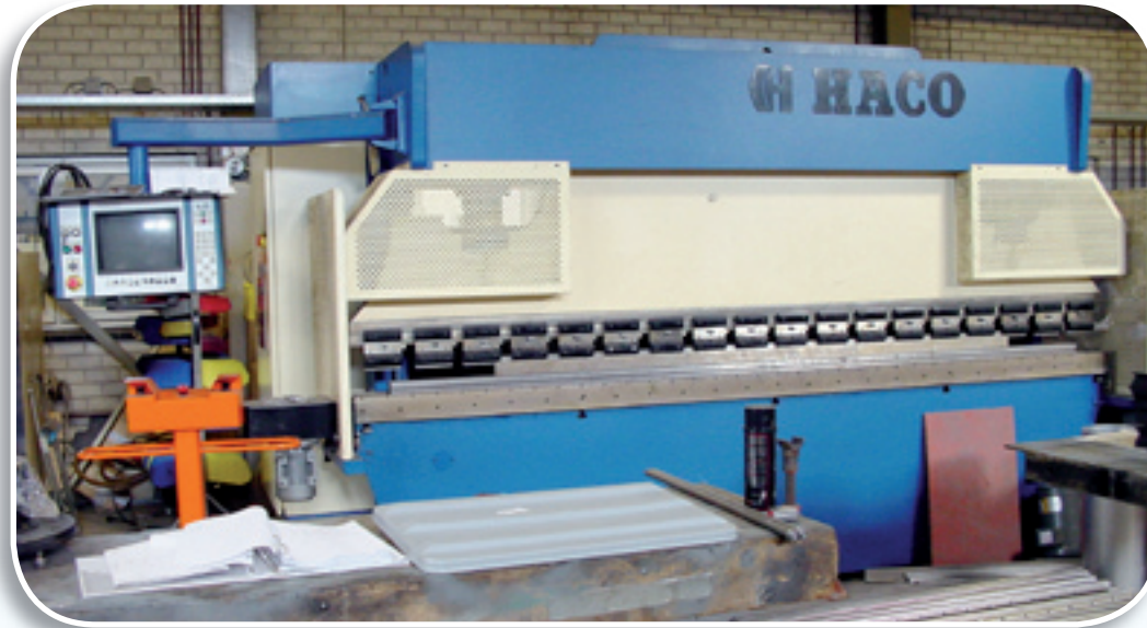
Haco type PRM36-135 kantbank bewerkingscapaciteit 3600 mm 135 ton
