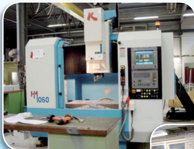
Kondia type HM 1060 18 gereedschappen wisselaar bewerkingscapaciteit 1060 x 600 x 500 mm
