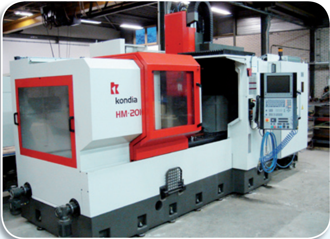
Kondia type HM 2010 40 gereedschappen wisselaar bewerkingscapaciteit 2000 x 1000 x 510 mm
