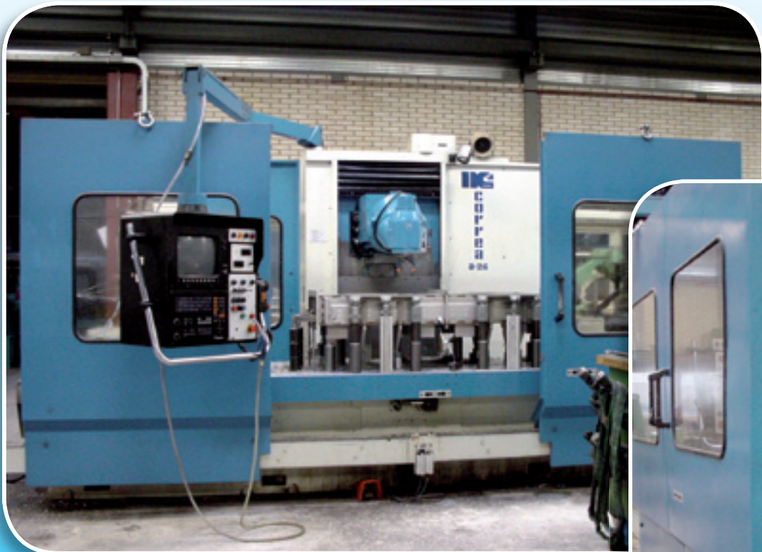
Corea type A25 Index freeskop bewerkingscapaciteit 3000 x 1000 x 1000 mm
