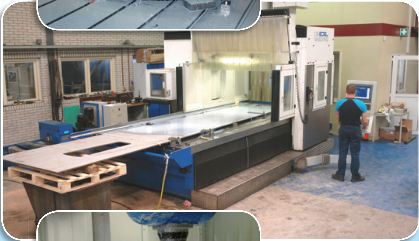
Edel Portaal bewerkingsunit type Cyport CP 3020 40 gereedschappen wisselaar bedafmetingen 5000 x 2310 mm bewerkingscapaciteit 3000 x 2000 x 960 mm.
