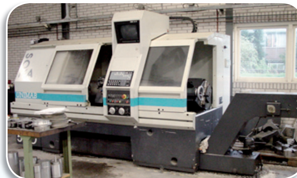
Casaneuve Unimab type 500 bewerkingscapaciteit rond 500 x lang 1500 mm
