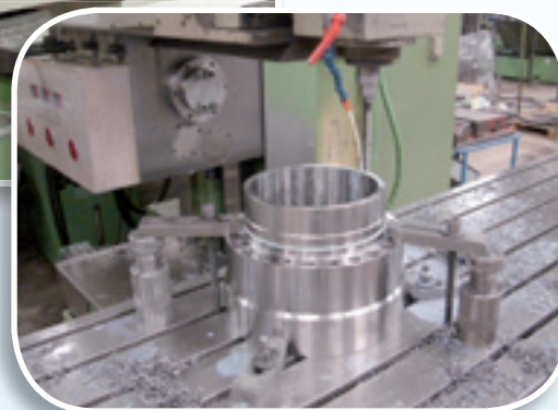
Kondia type HM 1060 18 gereedschappen wisselaar bewerkingscapaciteit 1060 x 600 x 500 mm
