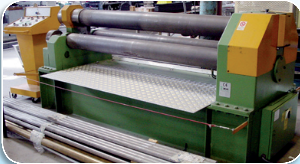
Imcar type S/HR 6/3 wals bewerkingscapaciteit 2000 mm 3,6 ton
