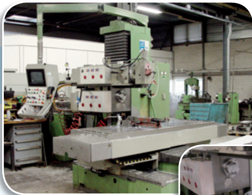
Fil type FA200 bewerkingscapaciteit 2000 x 700 x 700 mm
