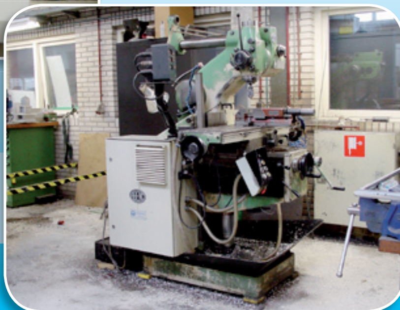
Abene type VHF-3-BS bewerkingscapaciteit 700 x 260 x 500 mm
