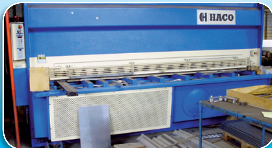
Haco type HSLX3013 schaar bewerkingscapaciteit 3000 x 13 mm
