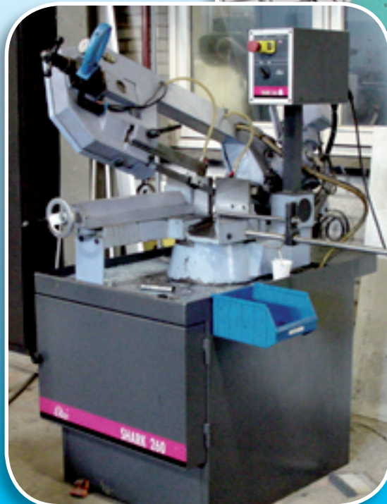
Shark type 260 lintzaag bewerkingscapaciteit rond 100 mm vlak 150 mm
