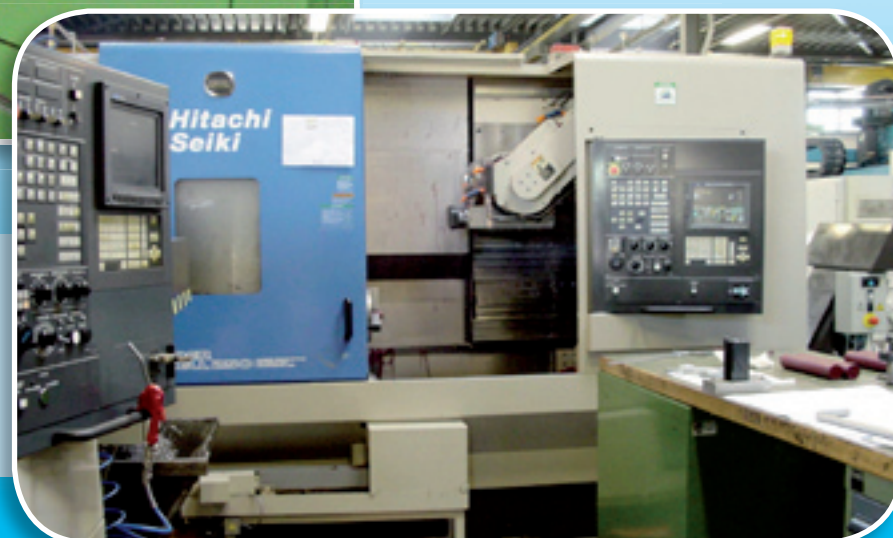
Hitachi type S Hicell 250 bewerkingscapaciteit rond 250 x lang 600 mm 24 gereedschappen wisselaar 5 assige besturing
