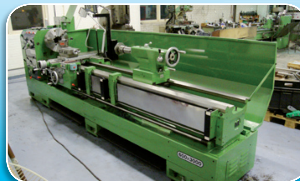
Stoxon Swing draaibanken bewerkingscapaciteit 1x rond 600 x lang 3000 1x rond 430 x lang 1500
