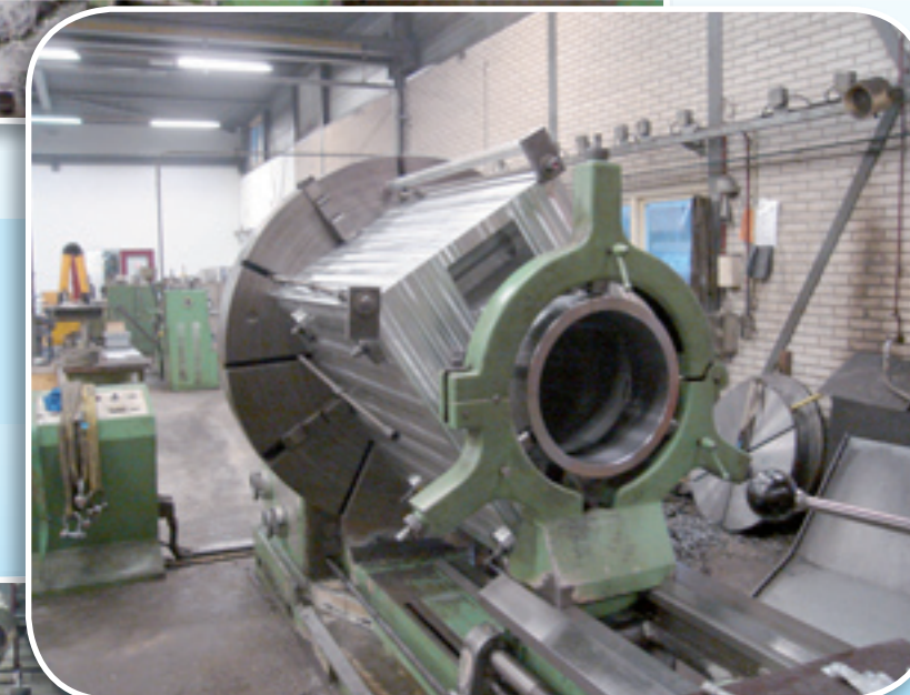
Est-Ticino type 520 bewerkingscapaciteit rond 1500 x lang 4000 mm
