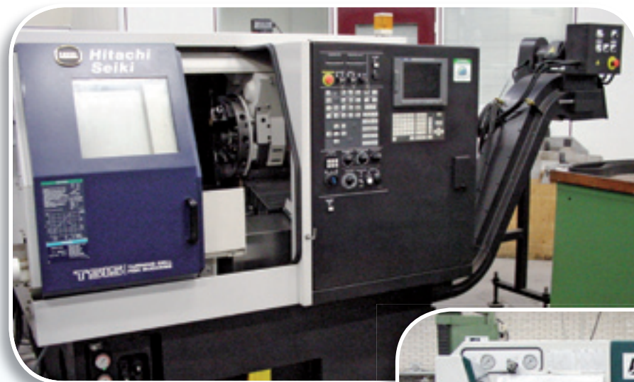
Hitachi type TS15 bewerkingscapaciteit rond 160 x lang 300 mm 12 gereedschappen wisselaar automatische stafaanvoer
