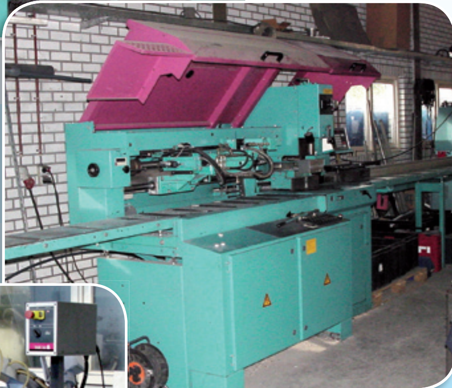
Kaltenbach type KKS400NA verticale zaag machine bewerkingscapaciteit rond 130 mm, vlak 190 mm Auto feeder / aanslag systeem
